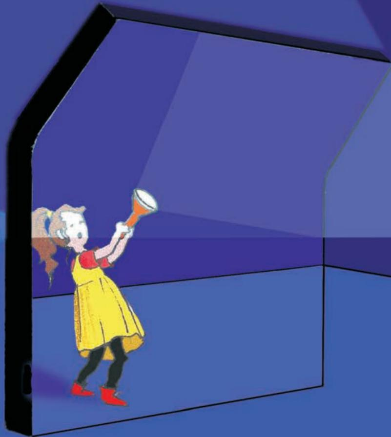
Ist die Wand jedoch eingebogen, muss Anna ihre Lampe viel steiler hinauf halten, damit das Licht nicht mehr zurückgeworfen wird. Somit ist hinter der Wand ein größerer dunkler – übersetzt also lärmgeschützter – Raum. „Spannend“, sagt sie. Mit einer gebogenen Schutzwand kann man also niedriger bauen und dabei doch die gleiche Wirkung erzielen wie mit einer höheren geraden Mauer.
