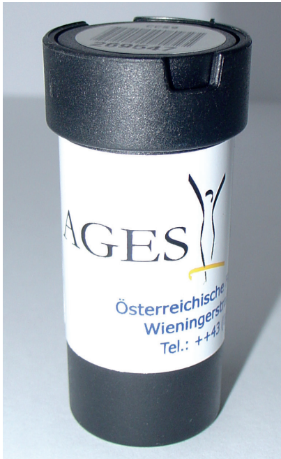
Abb. 2: Ein Passivsammler für Radon, wie er von der AGES zur Verfügung gestellt wird.
