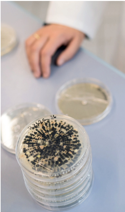
Abb. 2: Kultivierte Schimmelpilze nach einer Raumluftmessung.
